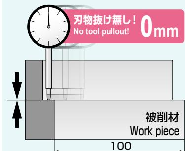
**ø20 4枚刃 超硬スクエアエンドミルでの加工例**
