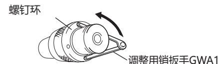
3. 调整结束后，用六角扳手锁紧螺钉环上的2处螺钉。
