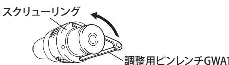
3. 調整が終わったら、スクリューリングの2箇所の止めねじを六角レンチで締めます。
